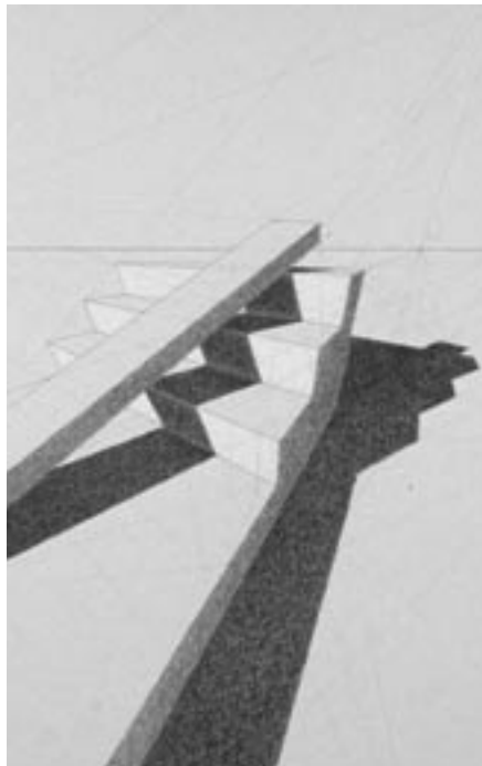
Abb. 13: Schattenkonstruktion in Perspektive für quaderförmige Objekte in Kippelage zur Bildebene (Nora Weichert, SS 2000)
